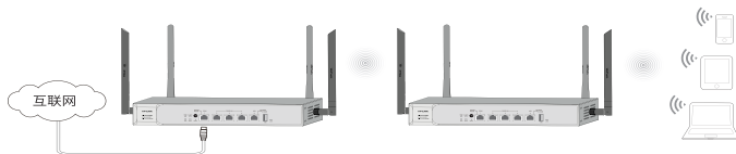
图5-1 开启设备集中管理功能的组网拓扑（一）
